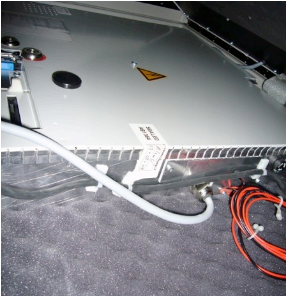
„Siegel“ am Computermodul eines deutschen NEDAP-Wahlcomputers
