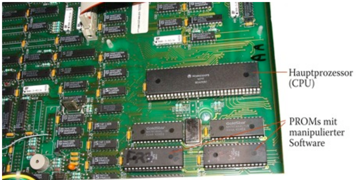
Hauptprozessor und PROMs auf Chipsockeln
