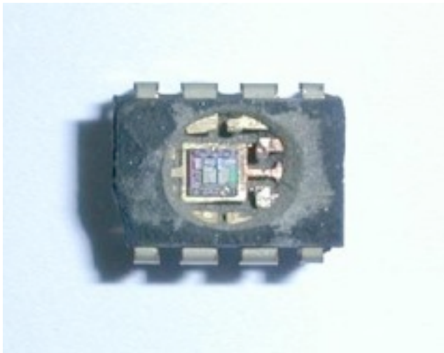
Chip mit sichtbarem Chipkern
