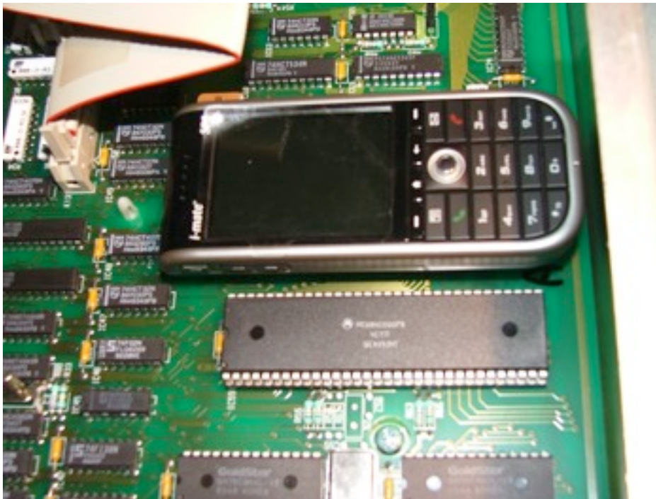
Größenvergleich Hauptprozessor des NEDAP-Wahlcomputers mit einem aktuellen Mobiltelefon
